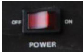
۱- کلید خاموش و روشن شدن دستگاه.
