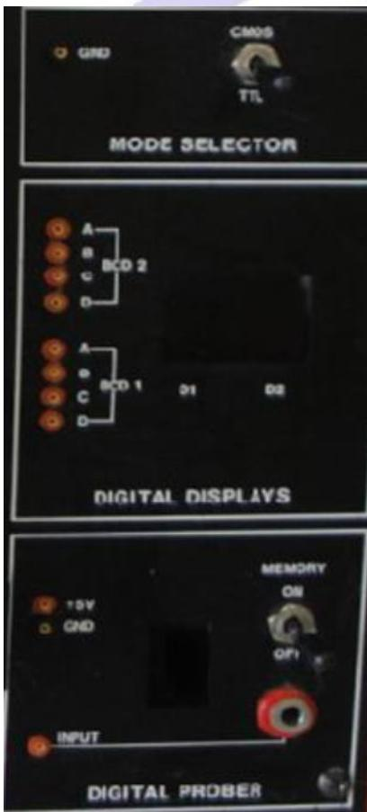
۷- در صورتی که از آی سی های CMOS یا TTL بطور جداگانه و با مدارات داخلی کیت استفاده شود، این ۳بخش از کیت برای آزمایشها و جواب گرفتن آنها، کاربرد دارند.
