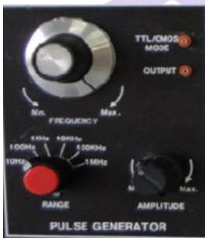
۳- سیگنال ژنراتور مربعی با کلیدهای مورد نیاز برای الف) تنظیم دامنه. ب) تنظیم فرکانس. از قسمت ، سیگنال مربعی تنظیم شده، به مدار داده می شود.
