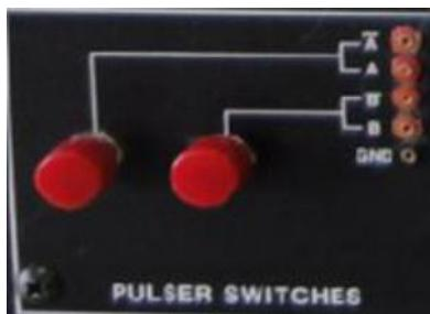
۴- کلیدهای (A or B). Push Button (A or B). با هر بار فشردن این کلیدها، یک پالس تولید می شود.
