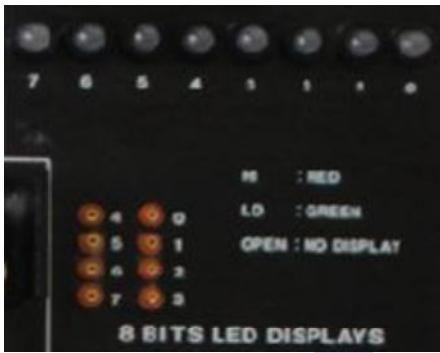
۶- دیودهای LED که در موقع لزوم در مدارهای مورد نظر برای نشان دادن صحت کار مدار استفاده می شوند.
