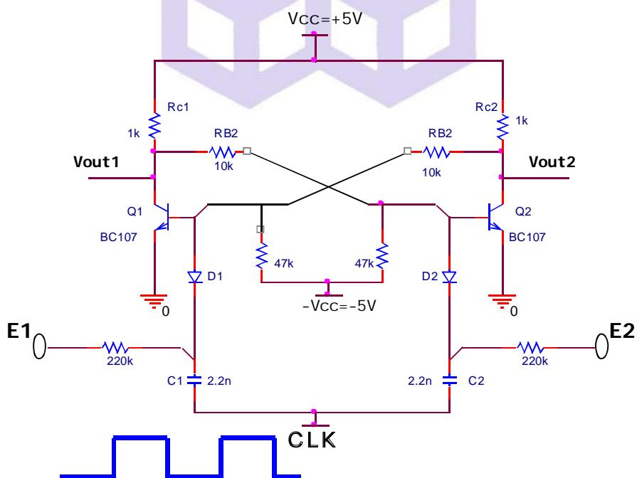
الف) از طریق ورودیها و یا سوئیچ های E1 و E2، به صورت جداگانه مدار را تحریک کنید(مثل حالت قبل). با وجود اعمال CLK، خروجی های Q1 و Q2 چگونه تغییر خواهند کرد؟
