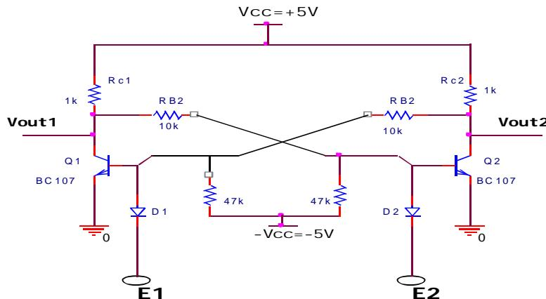
الف) از طریق ورودیها و یا سوئیچ های E1 و E2، به صورت جداگانه مدار را تحریک کنید (با استفاده از سوئیچ های
